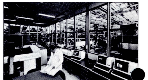
In Milaan (Italië) heeft Digital computers geïnstalleerd midden in de fabriekshal van Alfa Romeo om uitgebreide dynamica-tests te kunnen doen met iedere nieuw gemaakte automotor.
